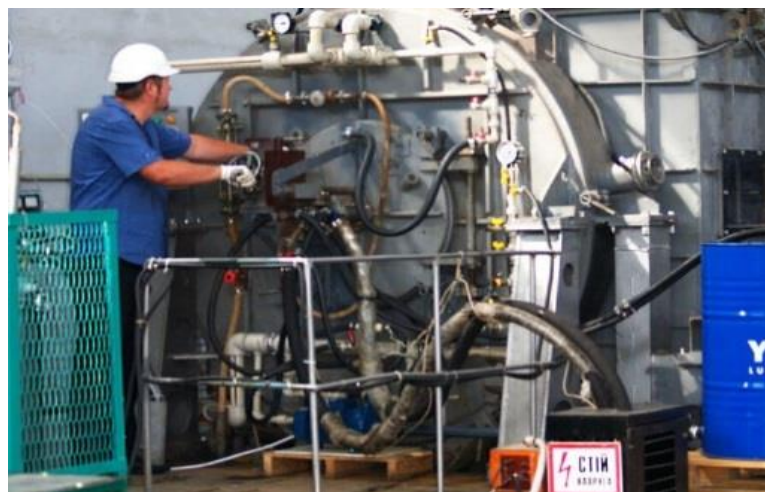
Рисунок 2 – Установка для розпилення методом PREP
