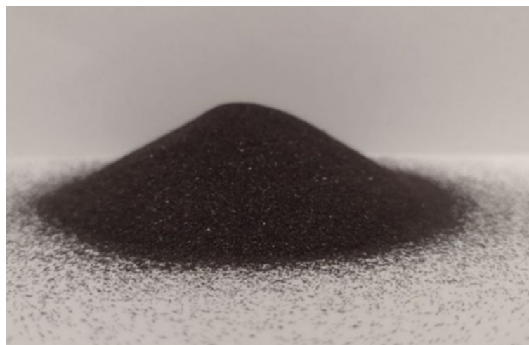
Рисунок 2 – Ільменітовий концентрат (65,2% \text{TiO}_2 , 1,1% \text{SiO}_2 ) Малишевське родовище, (Вільногірський ГМК, місто Вільногірськ, Україна)
