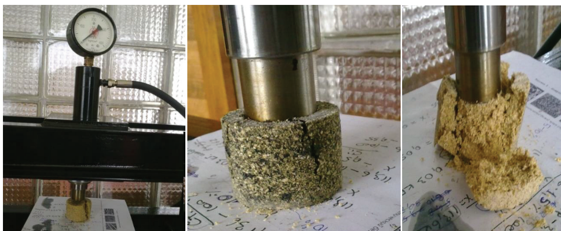
Рисунок 3 – Технологічний процес випробувань міцності на стискання зразків з відходів деревообробного виробництва
