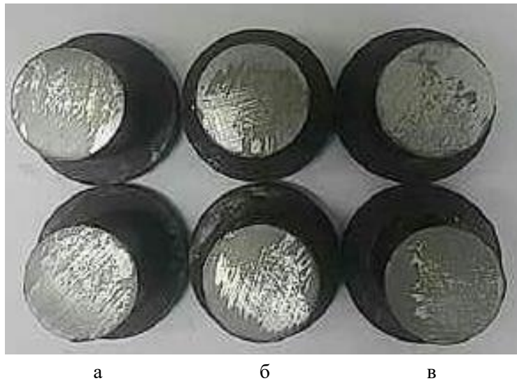
Рисунок 2 – Характер відриву (адгезійна міцність при відриві) епоксидних композитів із різним вмістом суміші дискретних волокон
