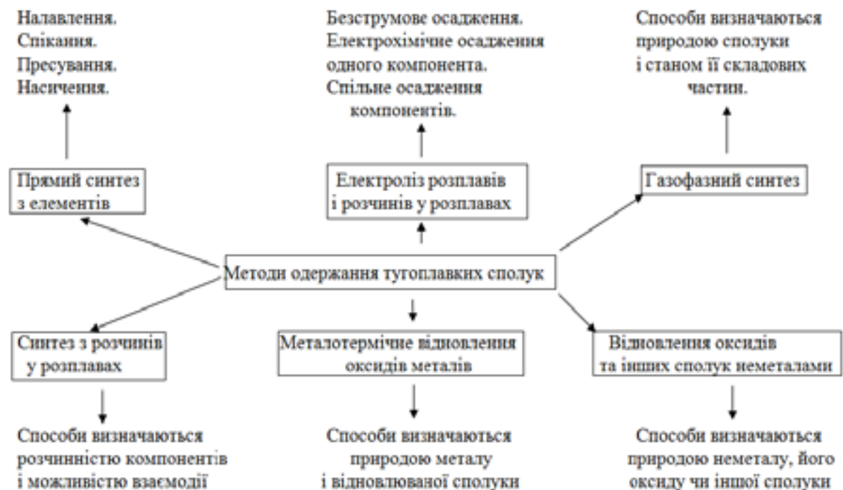
Рисунок 1 – Схема класифікації основних методів одержання тугоплавких сполук металів IV–VI груп
