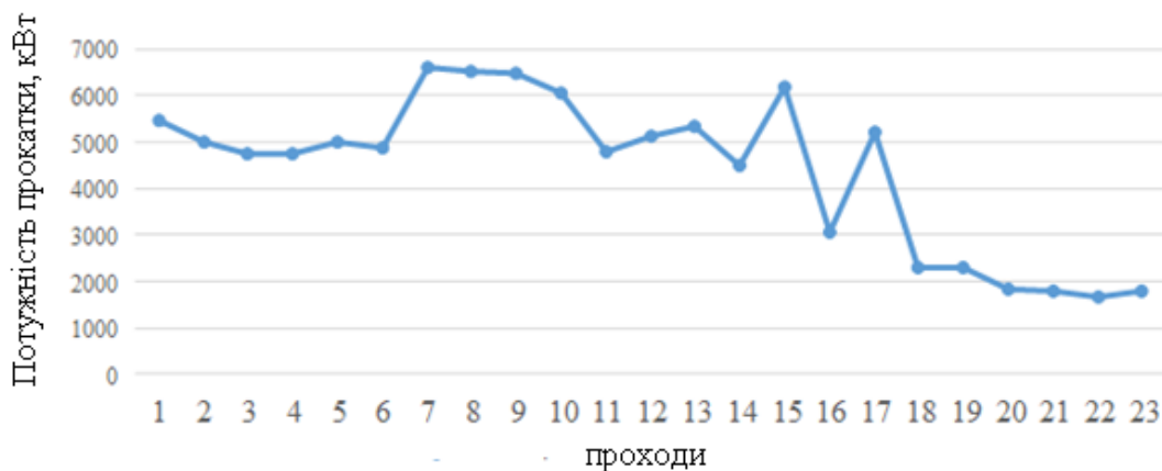
Рисунок 5 – Графічна залежність потужності двигуна за прокатки зливка перетином 590×590 від кількості проходів
