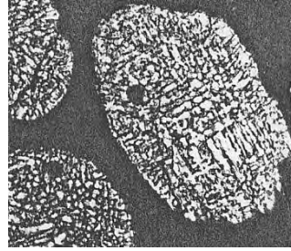
Рисунок 8 – Мікроструктура порошку ФМн1,5, отриманого розпиленням водою «у смерчі», фракція +63-100 мкм, \times 400
